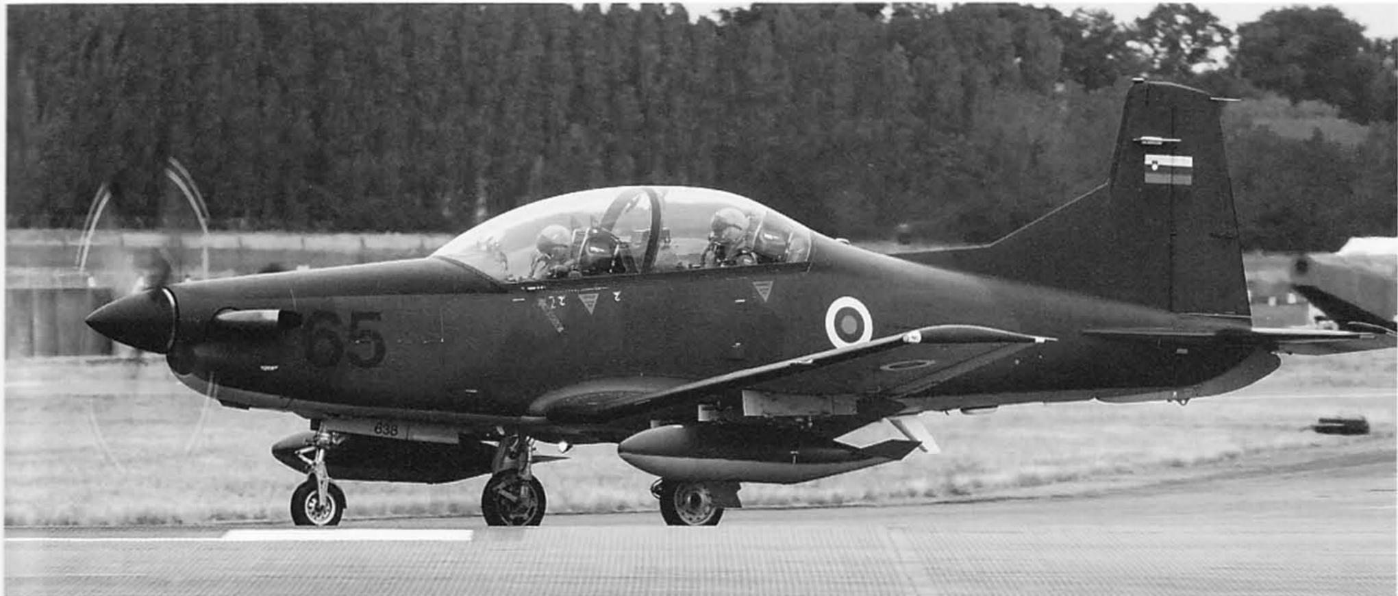
スロベニア空軍のPC-9フドウルニク。高等練習機PC-9の能力向上型PC-9Mに各種装備を追加した強化型。スロベニアはPC-9運用国の中で唯一、攻撃機としてこれを運用している (Photo: Alex van Noye)
